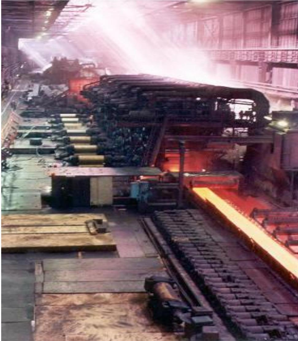
Цех производит горячекатаный прокат в рулонах и листах толщиной от 2,0 до 12,0 мм и шириной 900-1500мм, а также штрипс для электросварных труб
